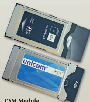
CAM Module geschikt voor het plaatsen van de smartcard van PAY TV programma's zoals canal digitaal en TV vlaanderen
