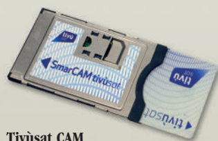
Tivùsat CAM module inclusief Smart Card Geschikt om Tivùsat programma's, ook HD, via satelliet met de Force HD CI+ ontvanger te bekijken.
