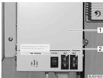
Afb. 150 Regelaar verwarming voor afvalwaterleidingen
