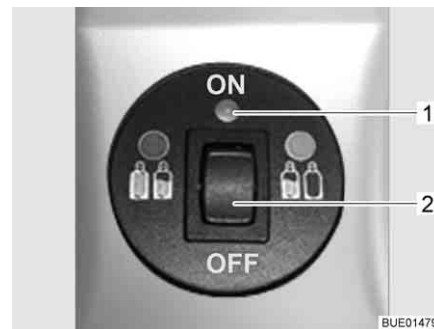
Afb. 135 Bedieningspaneel met afstandsindicatie
