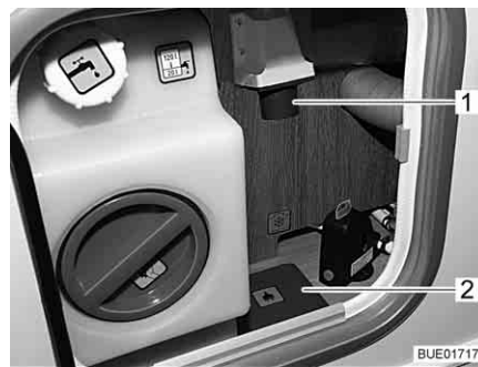
Afb. 144 230-V-aansluiting op het voertuig
